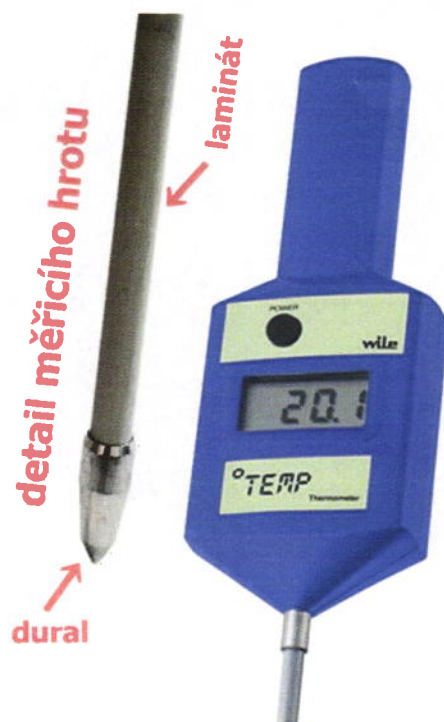
Teploměr a vlhkoměr WILE, přístroj na určení obsahu kyslíku v kompostu REDOX
